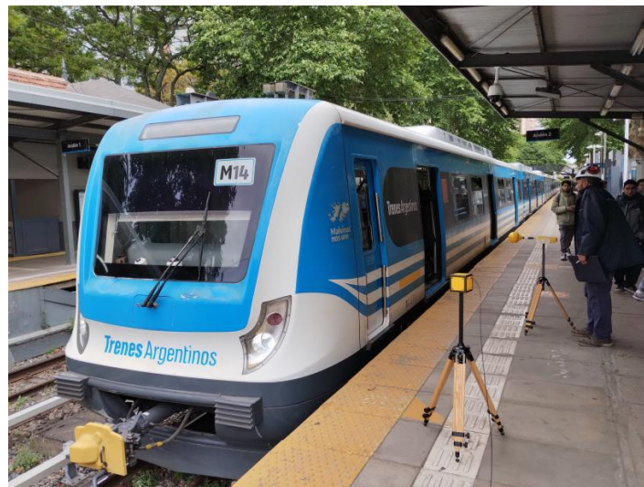
ILUSTRACIÓN 50 UBICACIÓN DE LOS EQUIPOS DE MEDICIÓN DE CAMPO ELÉCTRICO (SENSOR CÚBICO) Y CAMPO MAGNÉTICO (SENSOR ESFÉRICO) SOBRE EL ANDÉN DE LA ESTACIÓN OLIVOS . FUENTE: INFORME ITREE-LAT IL-041-23 - (2023)
